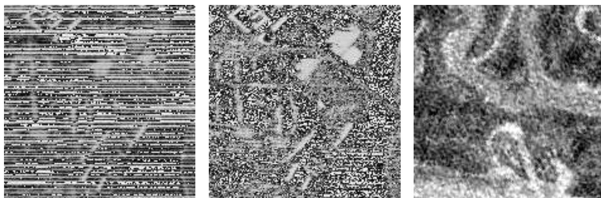
FIG. 3.10 – Canaux bruités typiques : respectivement Strasbourg (bande numéro 42 et 49 de DAIS) et la Lagune de Venise (bande numéro 45 de DAIS).
